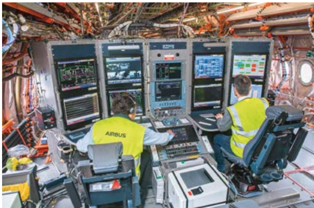
Avril 2023 : avion Airbus A350 XWB flightlab équipé pour des essais de vol alimenté par du carburant d'aviation durable remplaçant le carburant fossile conventionnel
