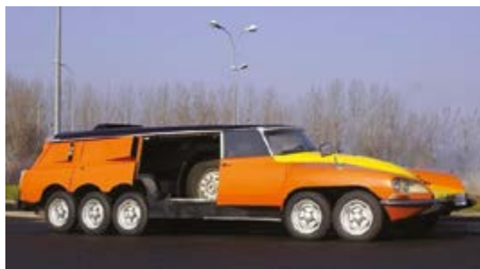
Le Mille-Pattes, véhicule de test conçu par Michelin. Collection du Patrimoine historique Michelin, Clermont-Ferrand.
