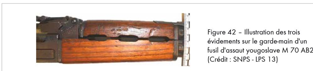
Figure 42 - Illustration des trois évidements sur le garde-main d'un fusil d'assaut yougoslave M 70 AB2
