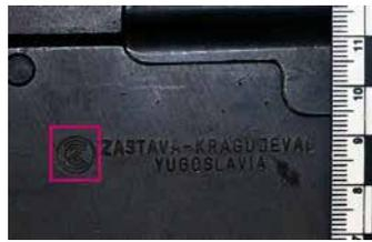
Vue détaillée du timbre d'usine, les lettres « ZCZ » pour Zavodi Crvena Zastava (matérialisées par le carré rose) sur le côté gauche de la carcasse
