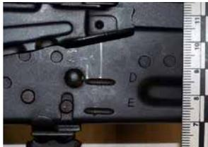
Vue détaillée des trois positions du sélecteur de tir sur le côté droit de la carcasse
