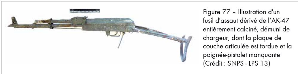
Figure 77 - Illustration d'un fusil d'assaut dérivé de l'AK-47 entièrement calciné, démuné de chargeur, dont la plaque de couche articulée est tordue et la poignée-pistolet manquante (Crédit : SNPS - LPS 13)
