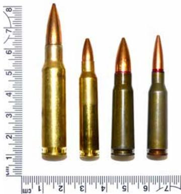
Figure 9 - Illustration de la différence de morphologie entre une balle ogivale pointue (ou pointue à base plate) et une balle bi-ogivale pointue (ou pointue de type *boat-tail*) (Huon (J.), 1986, Les cartouches pour fusils et mitrailleuses, Crépin-Leblond)
