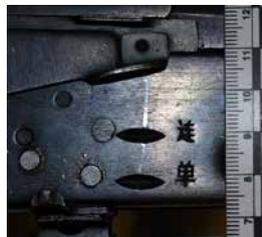
Vue détaillée des trois positions du sélecteur de tir sur le côté droit de la carcasse
