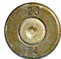
Figure 66 - Illustration de la trace du couvre-culasse découverte sur le cylindre dudit étui percuté de calibre 7,62×39 d'origine hongroise fabriqué en 1974. (Crédit : SNPS - LPS 13)
