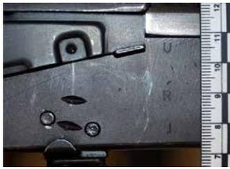
Vue détaillée des trois positions du sélecteur de tir sur le côté droit de la carcasse
