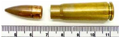
Figure 59 - Illustration du noyau en plomb d'une cartouche de 7,62×39 M 67 (Crédit : IRCGN)
