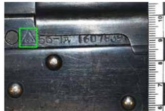
Vue détaillée du timbre d'usine, l'inscription « 66 » dans un triangle (matérialisée par le carré vert) sur le côté gauche de la carcasse
