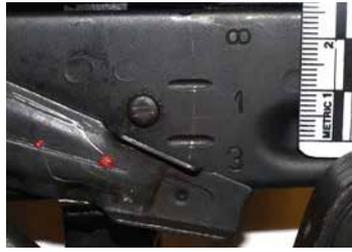
Vue détaillée des quatre positions du sélecteur de tir sur le côté droit de la carcasse
