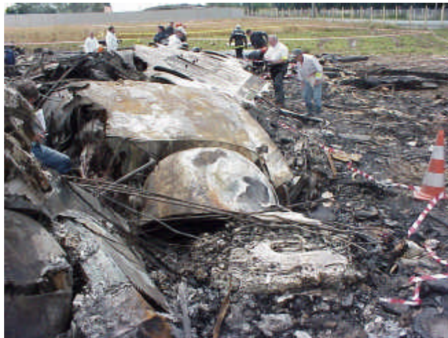
Vue générale de la tuyère secondaire supérieure du moteur n° 4
