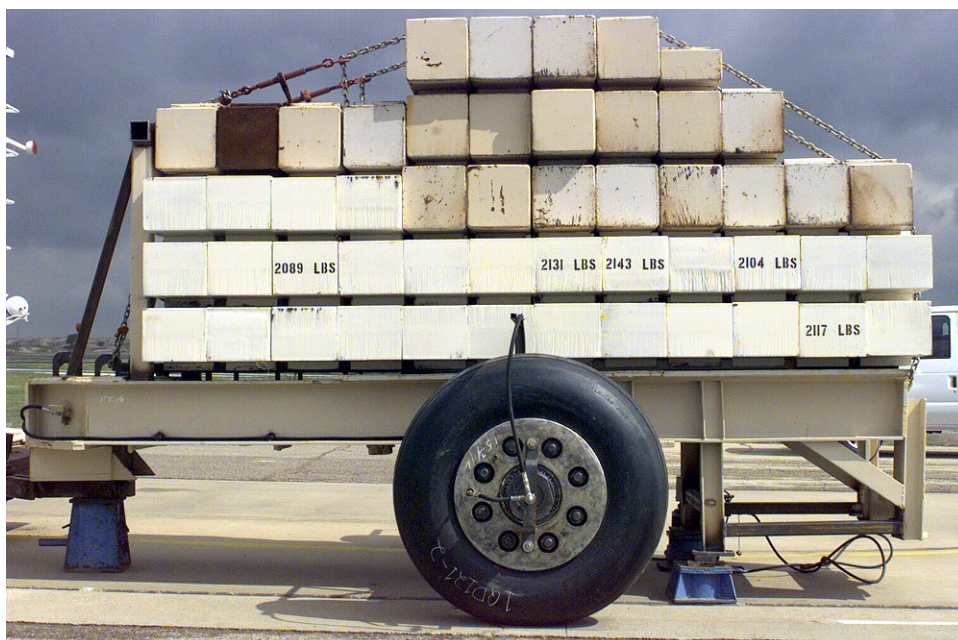
Figure 22 : installation d'essai des pneus
