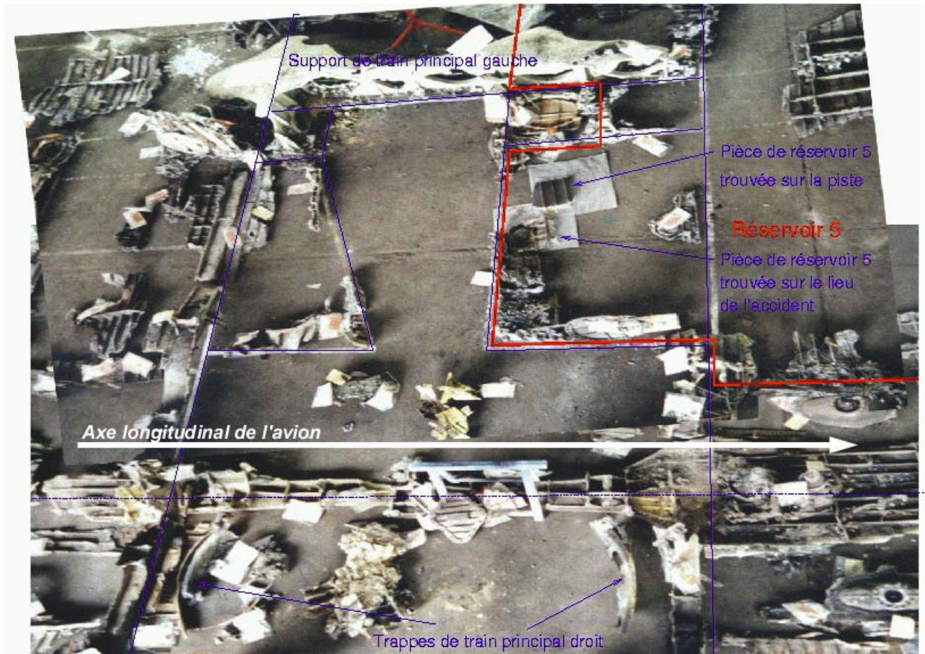
Figure 13 : Vue de la reconstitution de l'aile dans le hangar
