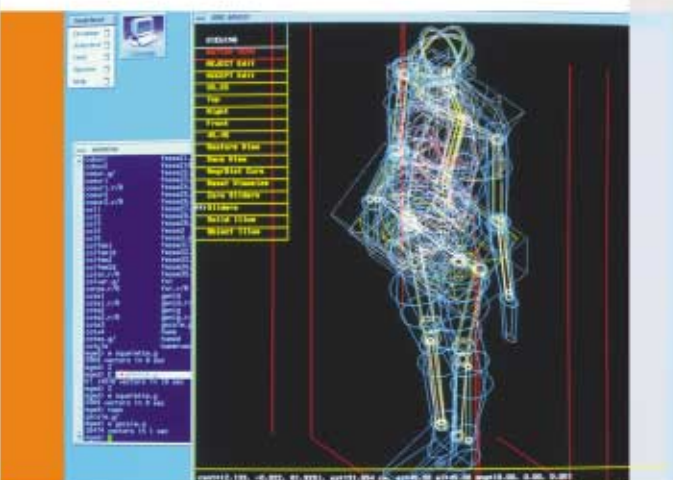
Modèle numérique utilisé pour la reconstitution dosimétrique par calcul dans le cas d'un accident radiologique.
