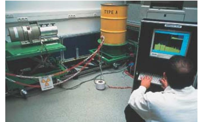
PLUM, banc de mesure du Plutonium dans les fûts de déchets.
