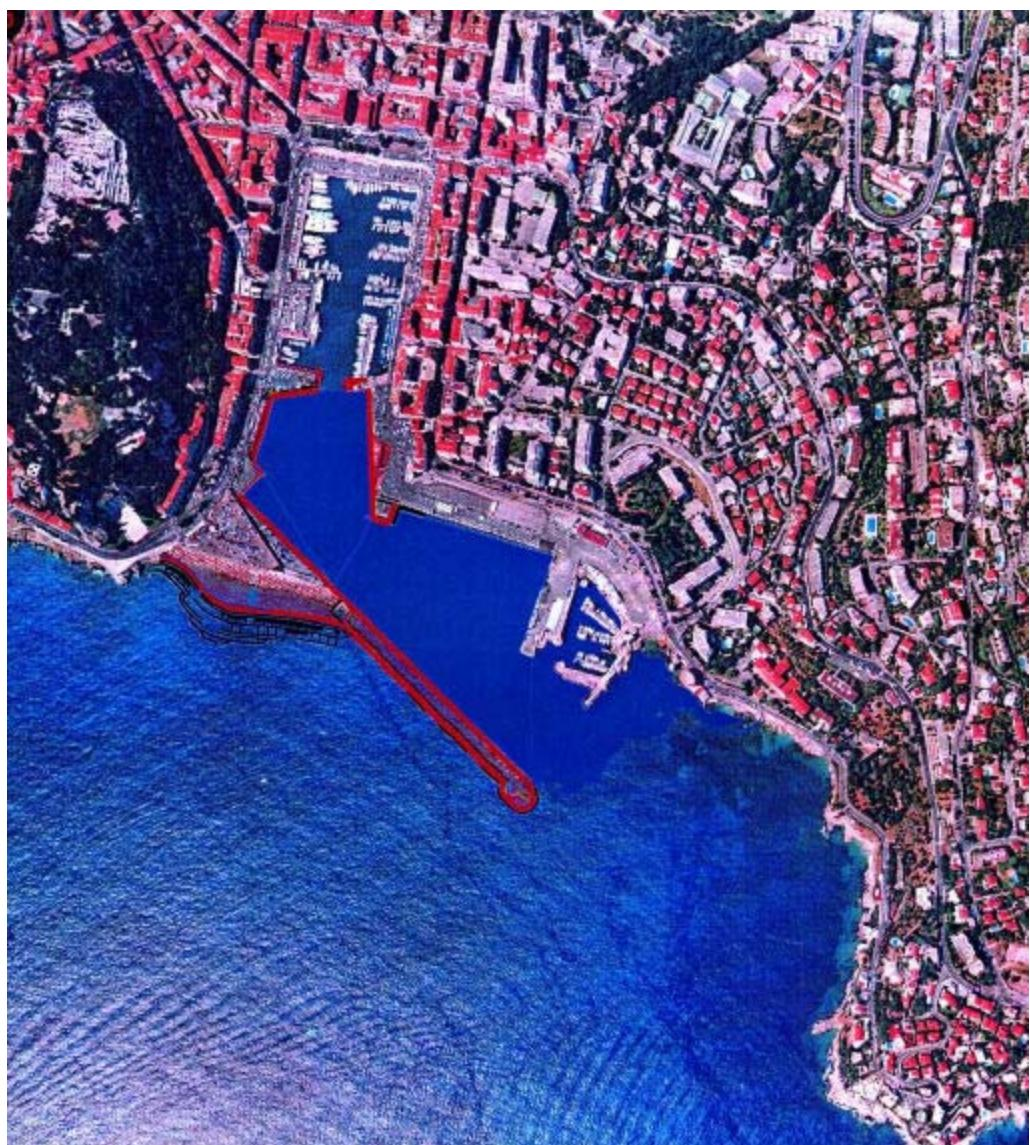
L'emprise sur la mer peut être évaluée au total à **13000 m<sup>2</sup>**, dont 4500 environ pour la rectification de la digue existante elle-même et le reste, soit 8500 m<sup>2</sup>, pour la construction du terre-plein et de la nouvelle digue extérieure qui le protègera.
