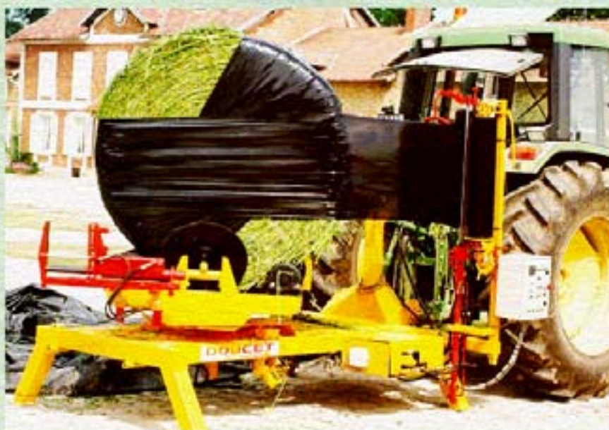
Principe d'une enrubanneuse - (Doucet)
