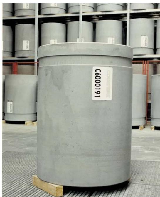
Conteneur béton fibres cylindrique (CBF-C) contenant des déchets technologiques bloqués dans un liant hydraulique
