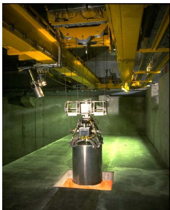
Fût contenant des boues de traitement d'effluents incorporées dans du bitume
