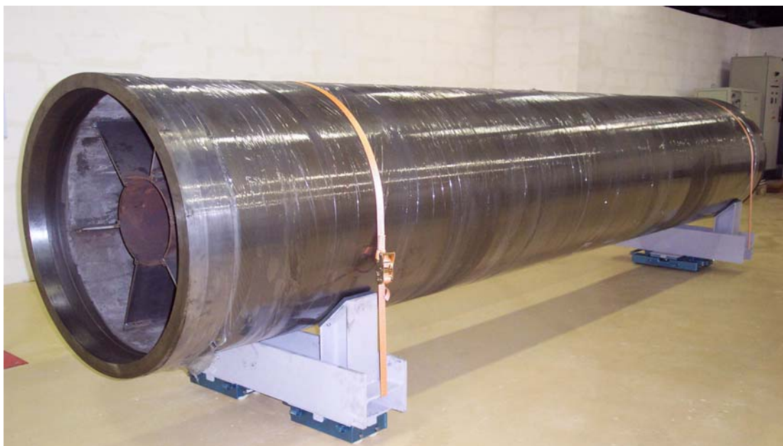
Conteneur d'entreposage moulé en fonte, avec insert acier (échelle 1)
