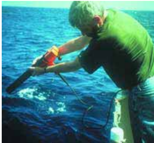
Lancement d'une sonde XBT ( expendable bathythermograph ) ; capable de mesurer la température de l'eau jusqu'à 800 m de profondeur, elle a permis d'étudier la structure thermique profonde du Pacifique.
