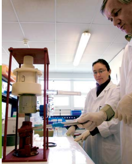
Presse à sédiment permettant d'extraire les eaux interstitielles en vue de leur analyse.
