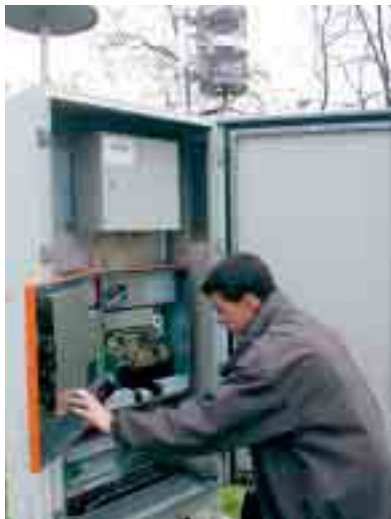
Intérieur d'une balise SARA (surveillance des aérosols).
