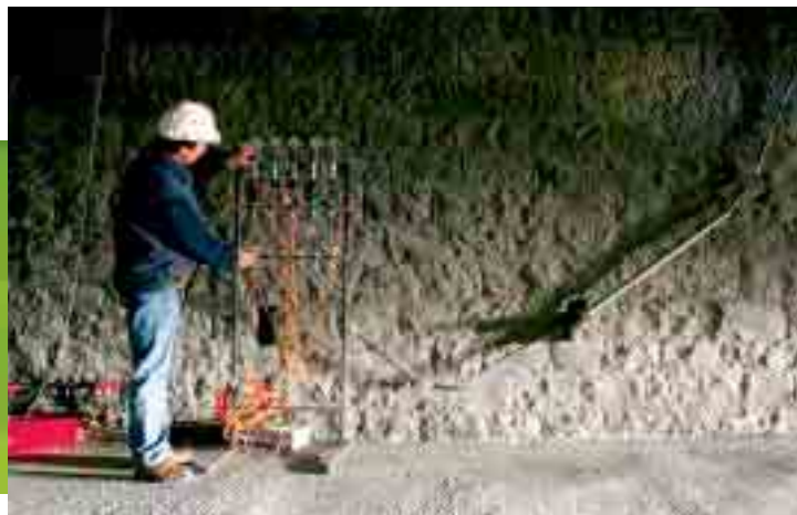
Instrumentation permettant de suivre l'évolution de la roche suite à un forage.
