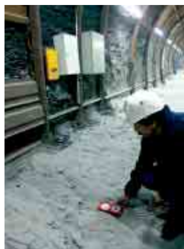
Mesure de l'orientation des fissures dans une galerie de tunnel de Tournemire (Aveyron).
