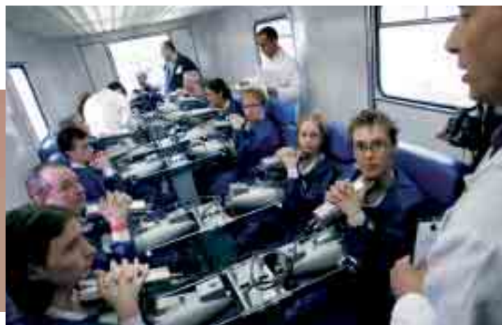
Dans le camion LMR de l'IRSN, 12 personnes peuvent être contrôlées en parallèle au niveau de la thyroïde ou du thorax.
