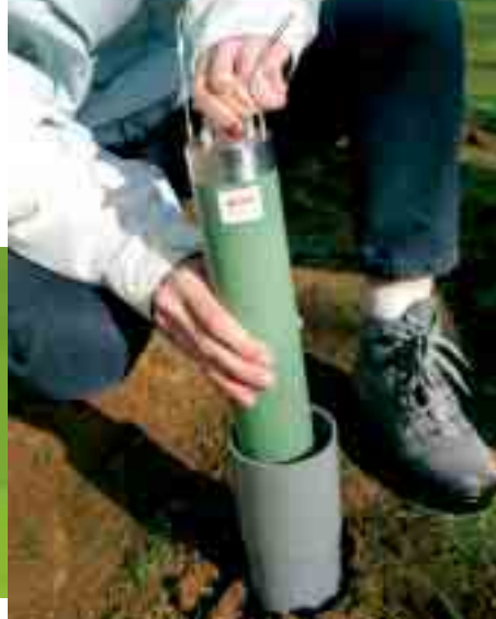
Sonde de mesure de la concentration du radon dans le sol.
