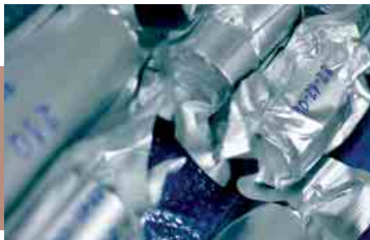
Conditionnement sous vide de carottes d'argile prélevées à Tournemire en vue de leur analyse chimique en laboratoire.
