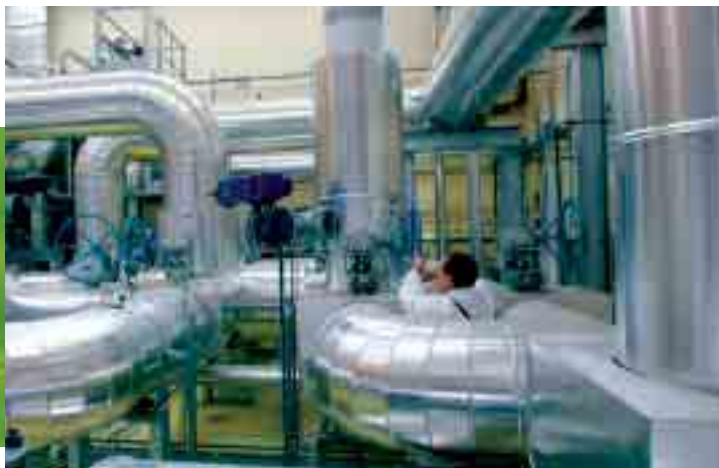
Soufflante à l'échelle 1 pour tester la résistance des filtres THE et clapets coupe-feu en pression (STARMANIA).
