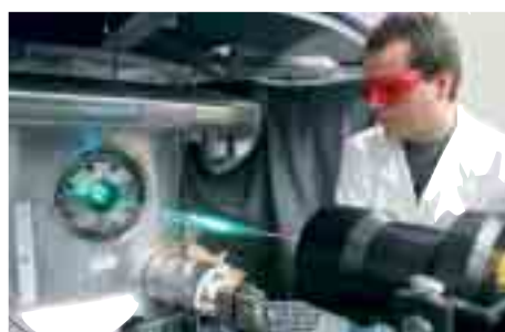
Appareillage pour les mesures laser, une nouvelle technique : la réfractométrie arc-en-ciel.
