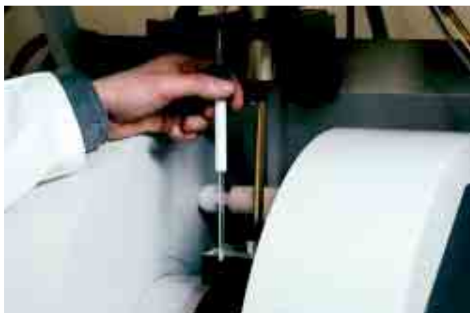
Accidents d'irradiation et de contamination - Mise en place d'un échantillon à mesurer par spectrométrie par RPE.
