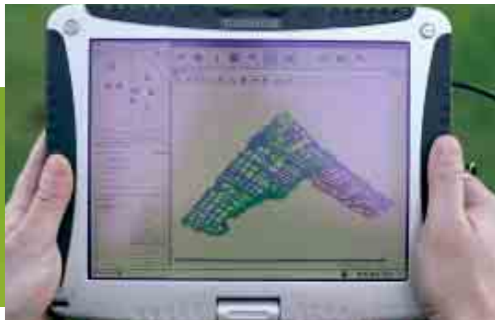
Cartographie du débit de dose gamma en temps réel en fonction de la position géographique.
