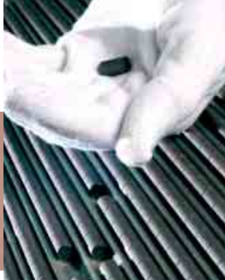
Pastille d'UO 2 constituant le combustible d'un REP.
