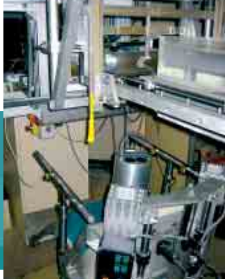
Mesure à l'aide d'un compteur proportionnel équivalent tissu auprès de la ligne de faisceau de protons du CPO.
