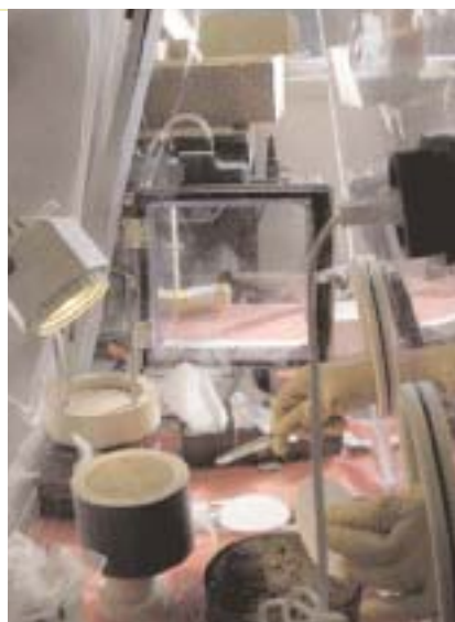
Extraction de l'eau interstitielle de sédiments prélevés en mer.
