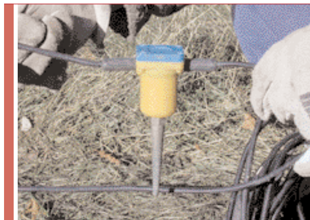
Géophone utilisé pour l'enregistrement sismique.
