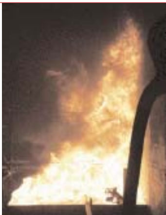
Feu d'une nappe de solvant du programme d'essais FLIP (Feu de liquide en interaction avec une paroi).
