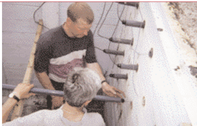
Plateforme expérimentale de Tchernobyl : pose de sondes de prélèvement d'eau.
