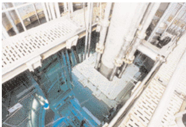
Vue de la piscine et du cœur CABRI (installation du CEA).
