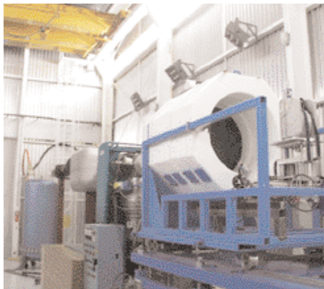
L'IRSN dispose de moyens uniques en France pour la dosimétrie des neutrons : ici le dispositif modérateur CANCEL.
