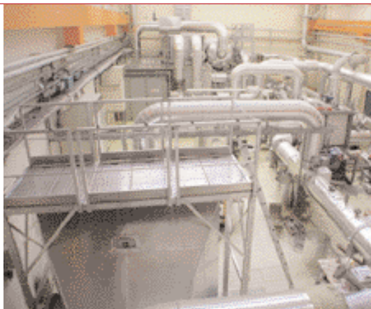
Banc d'essais Starmania destiné à l'étude du comportement des équipements de confinement et de sectorisation en cas de feu.
