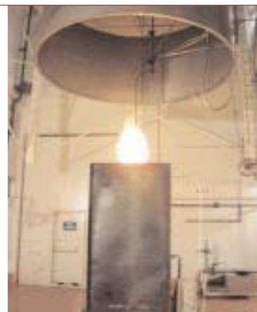
Essai du programme CARMELA visant à étudier la combustion des armoires électriques.
