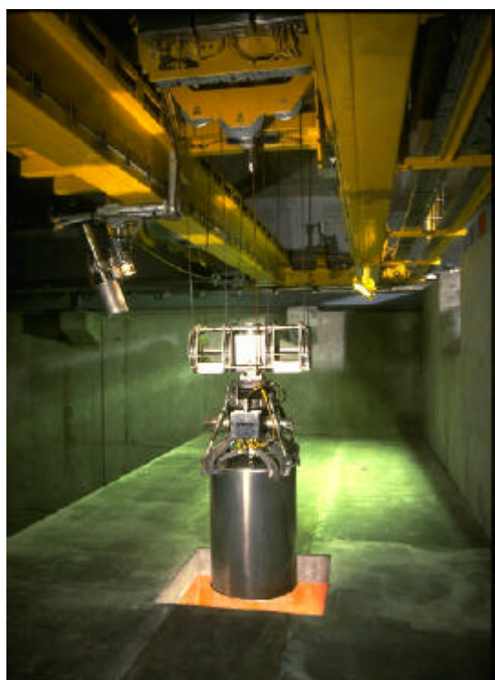
Fût contenant des boues de traitement d'effluents incorporées dans du bitume
