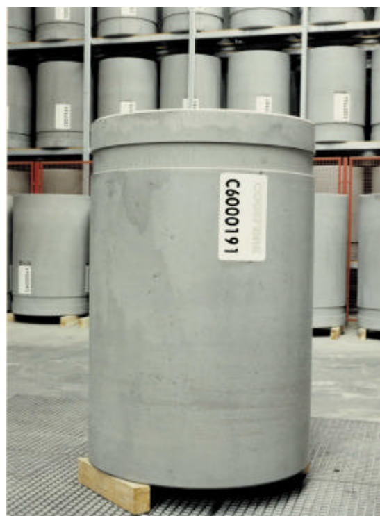
Conteneur béton fibres cylindrique (CBF-C) contenant des déchets technologiques bloqués dans un liant hydraulique
