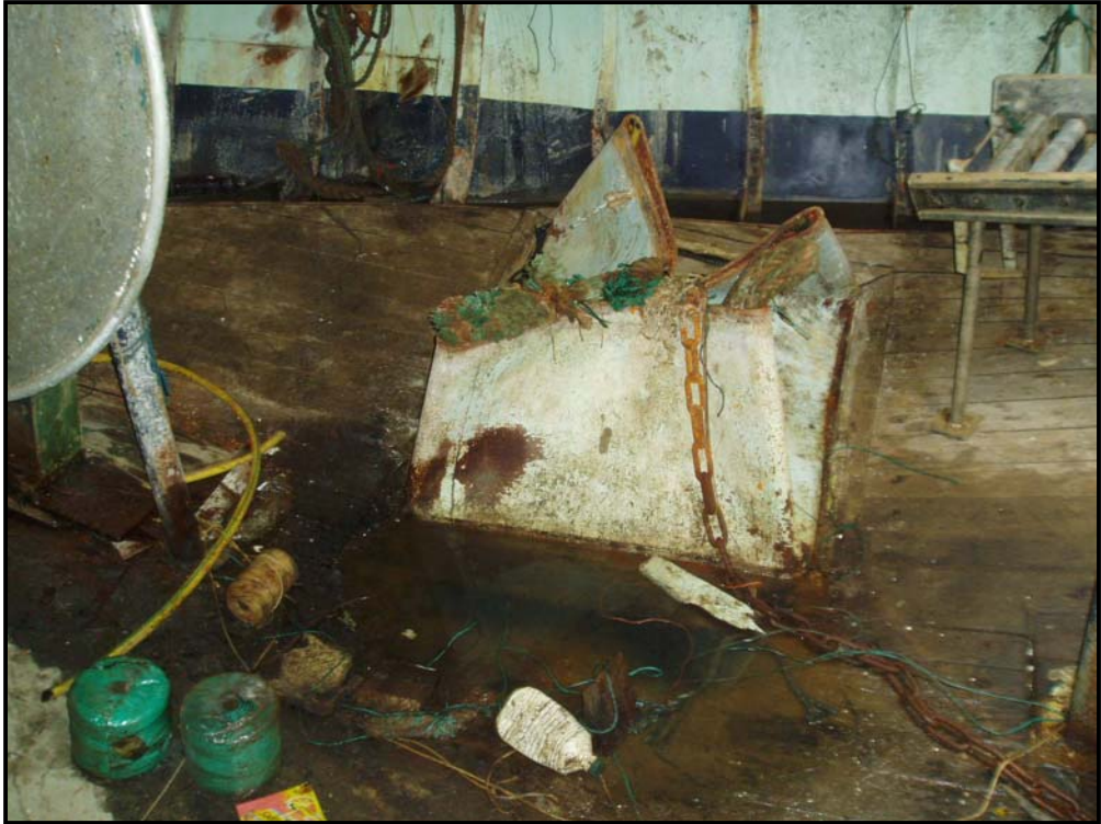
Déformation de l'écouille de chargement du poisson à tribord avant de la salle de travail.
