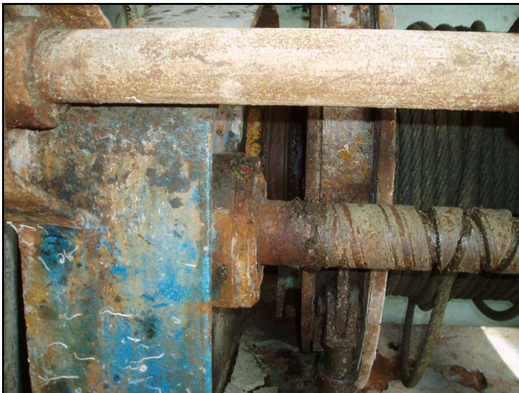
Détail du clabot du treuil bâbord.
