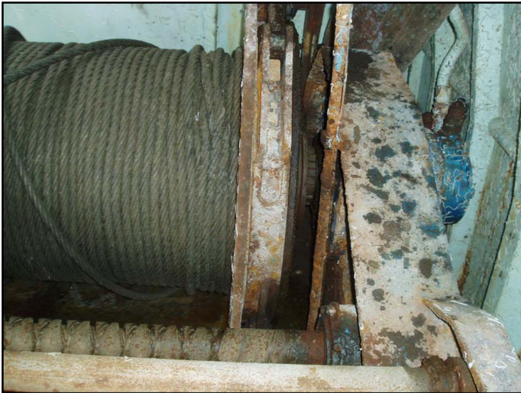
Vue du treuil tribord montrant que la poupée est déclabotée.
