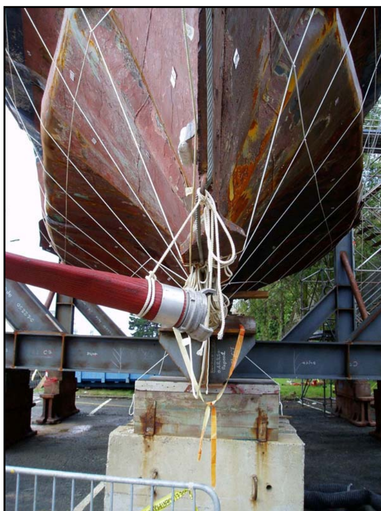
Photographie prise de l'avant montrant la symétrie des déformations.
