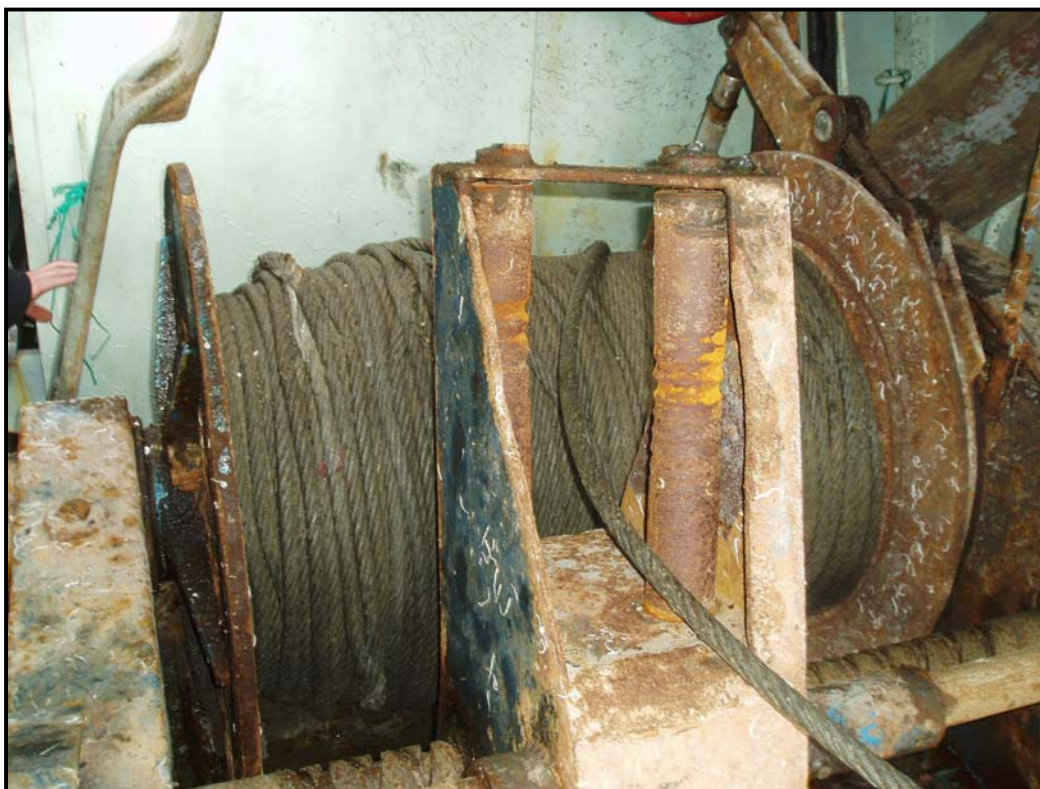
Vue du guide câble du treuil tribord.
