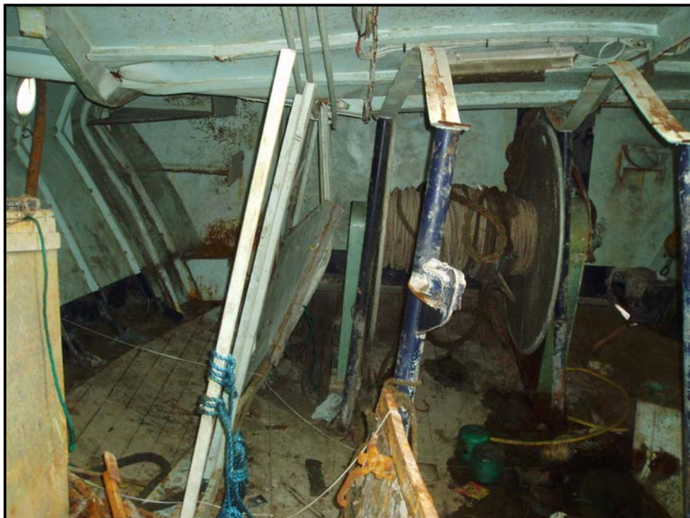
Vue des déformations au niveau du pont principal. La photographie est prise de l'arrière de la salle de travail.
