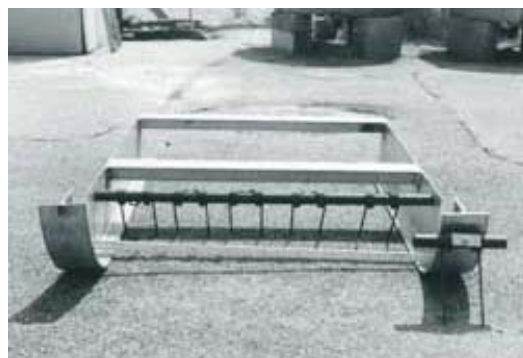
Traîneau pour semis sous-marin développé par l'Université du Rhode Island (source : EPA)
