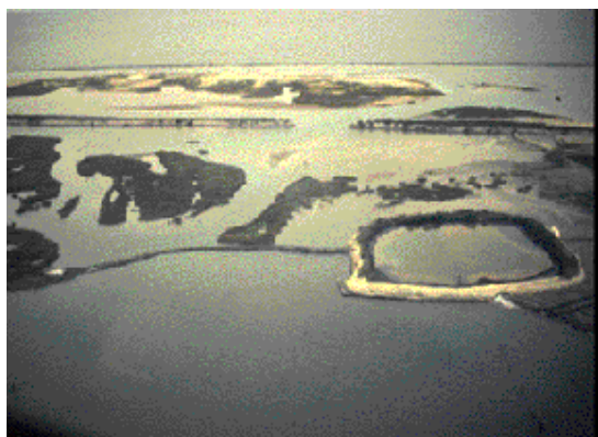
Restauration de marais par poldérisation : construction de digues (source NOAA)
