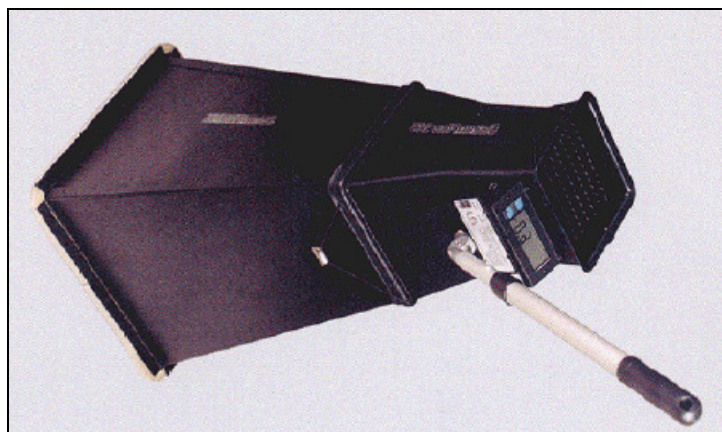
Figure 5-1 : SWEMAFLOW 233, débitmètre portatif utilisé par les techniciens enquêteurs pour mesurer les débits d'air aux bouches d'extraction.
