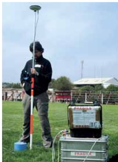
Mise en place du dispositif de mesures pour la caractérisation des milieux géologiques au Chili.
