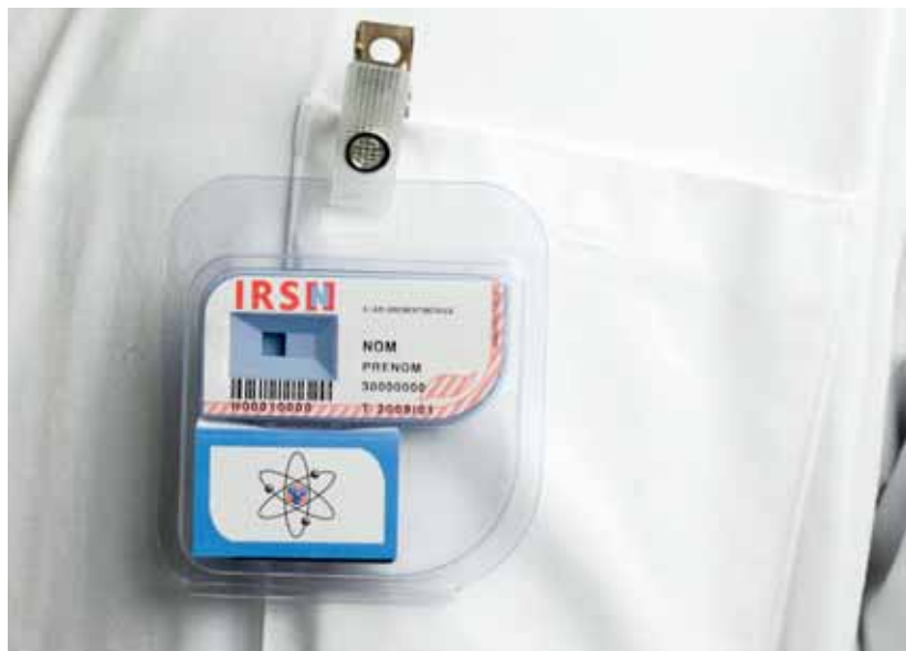
Le nouveau dosimètre photon-bêta-neutron fourni par l'IRSN.
