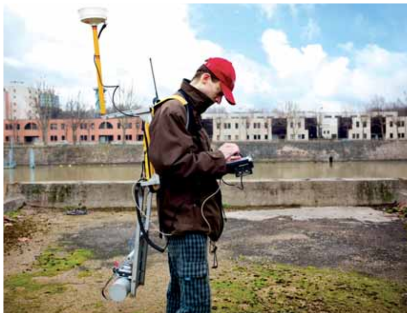
Réalisation d'une cartographie radiologique de surface sur le site de l'île Saint-Denis.
