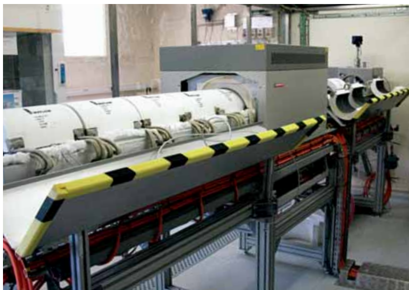
Four à gradient de température de la ligne phénoménologique de CHIP.
