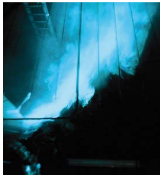
Essais de propagation des fumées par les portes (PRISME DOOR).
