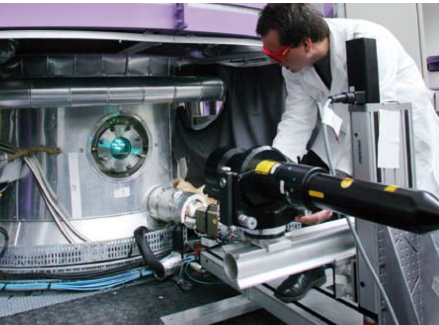
Mise en place de l'appareillage expérimental de TOSQAN.
