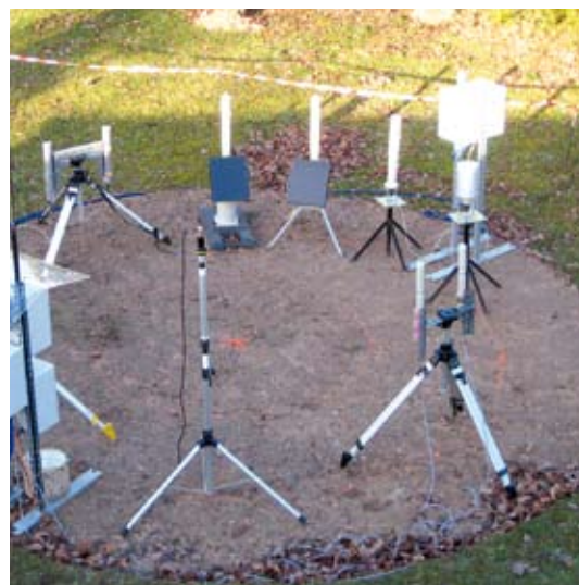
Plate-forme d'évaluation des instruments de mesure du débit de dose gamma ambiant en vue de la modernisation du réseau Télecray.
