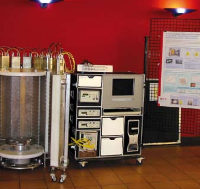
Dispositif de mesure de la masse de plutonium dans des fûts de déchets.
