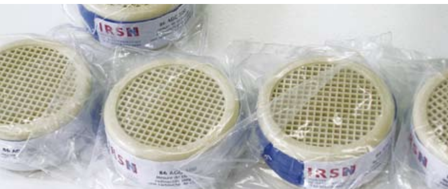
Cartouches filtrantes marquées à l'iode radioactif pour envoi aux participants à un essai interlaboratoires.
