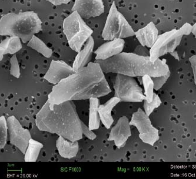
Micrographie du carbure de silicium utilisé dans des essais de remise en suspension des poudres.
