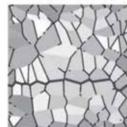
c) Simulation de la propagation de la fissure
