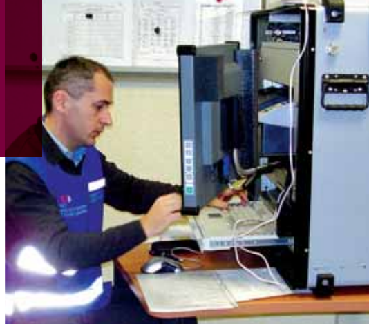
Prototype de mallette de communication satellite embarquée dans tous les moyens mobiles de nouvelle génération.
