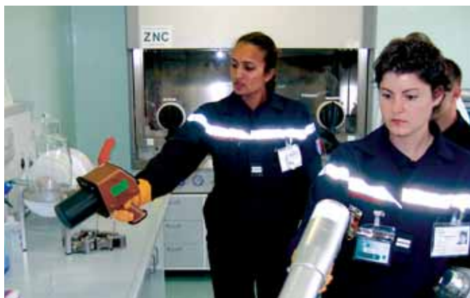
Recherche d'une contamination en cellule chaude.
