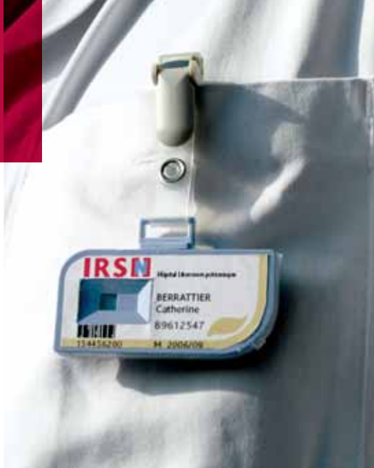
Prototype du dosimètre RPL.
