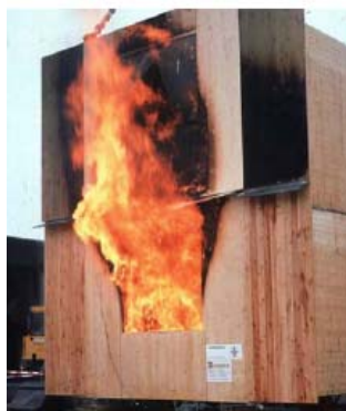
1.1 - Feu dans un compartiment composé de revêtement de parois combustibles (test 1)
