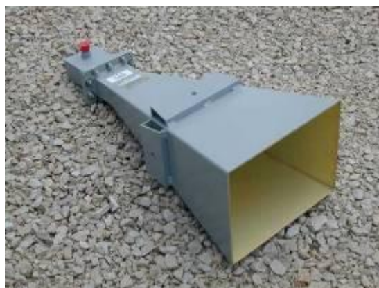
Figure 11 : Exemples d'antennes d'illumination hautes fréquences : log-périodique (1), cornet (2)
