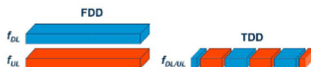
Figure 77 : Les deux modes de duplexage (sens DL en bleu et sens UL en rouge)
