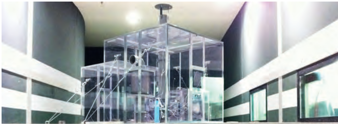
••• Un grand nombre d'essais en soufflerie ont été menés sur une maquette de bâtiment représentative d'installations de référence équipées d'un réseau de ventilation permettant ainsi de mesurer les débits de fuite.
