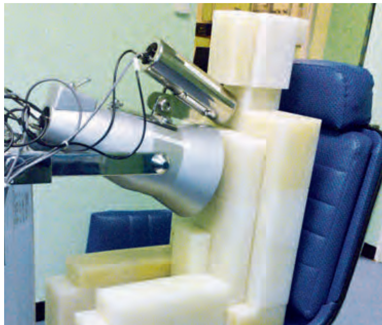
●-● Fantôme anthropomorphe IGOR ayant servi à tester les installations d'EDF pour les mesures anthroporadiométriques.
