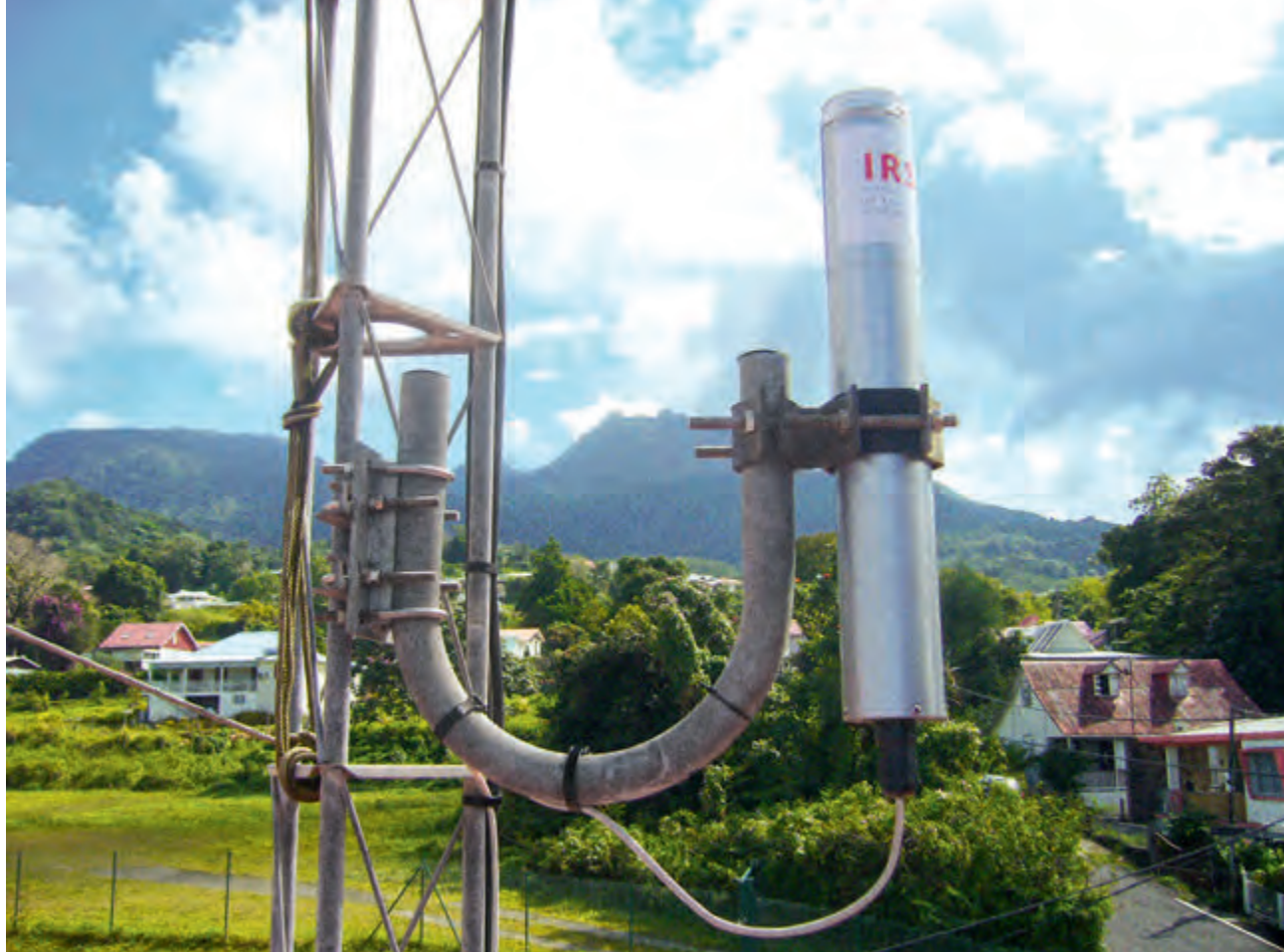
► Le déploiement des nouvelles sondes Téléray a commencé dans les départements, régions et collectivités d'outre-mer. Ci-dessus, la balise installée en mars 2011 à Saint-Claude (Guadeloupe) pour la surveillance de la radioactivité gamma de l'air ambiant.
