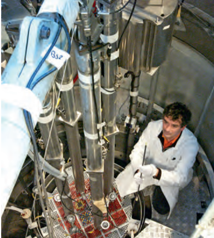
•• Le réacteur ÉOLE (comme le réacteur MINERVE) sert essentiellement aux études neutroniques des réseaux de combustibles thermiques.
