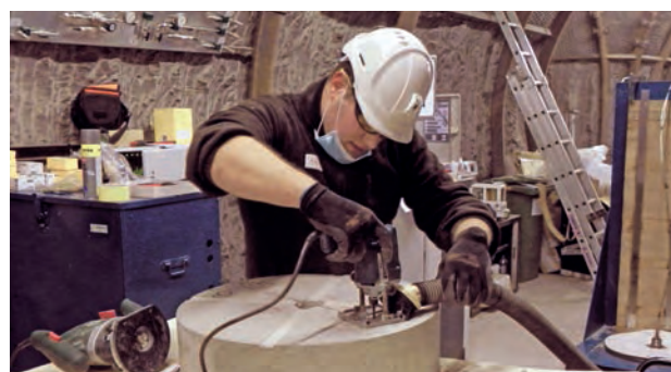
■ L'IRSN étudie l'efficacité et la tenue dans le temps des scellements au sein du tunnel de la station expérimentale de l'IRSN de Tournemire (Aveyron).
