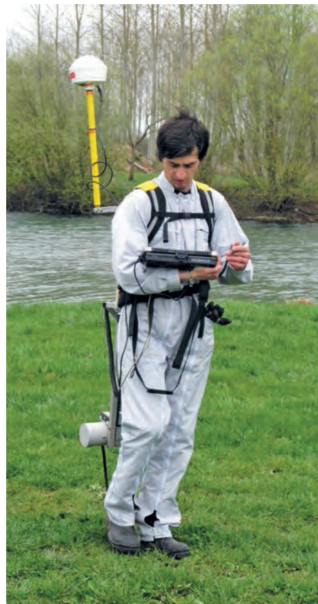
■ Cartographie de la pollution radioactive du site réalisée à partir de la mesure du rayonnement gamma.
