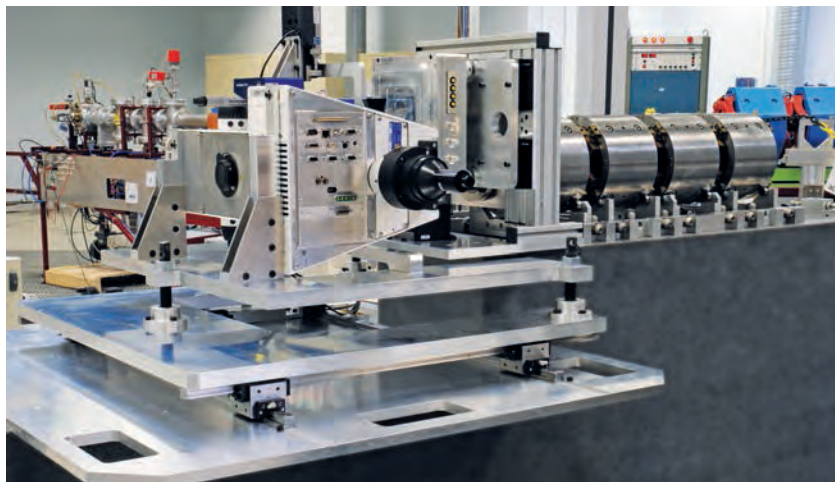
■ Prototype de la ligne microfaisceau de MIRCOM développé par le Centre d'études nucléaires de Bordeaux-Gradignan (Gironde).
