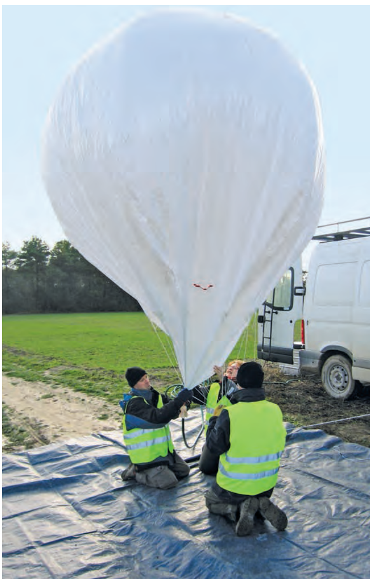
■ Préparation du ballon captif de l'IRSN en vue de mesures du gaz traceur en altitude.
