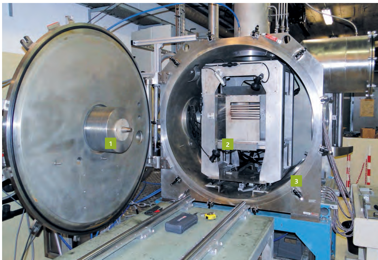
■ Les travaux menés en commun avec le Laboratoire des technologies d'assemblage du CEA, à Saclay, ont été réalisés à l'aide du laser continu YAG 8 kW de l'installation DÉLIA (DÉcoupe Laser Immergée et en Air). 1. Tête de découpe du laser. 2. Plaque d'acier. 3. Cellule immergeable.
