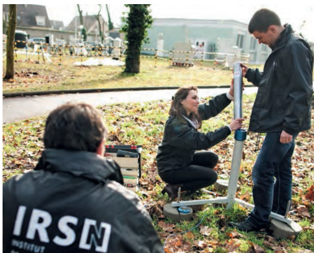
■ Test d'une balise Téléray de nouvelle génération.
