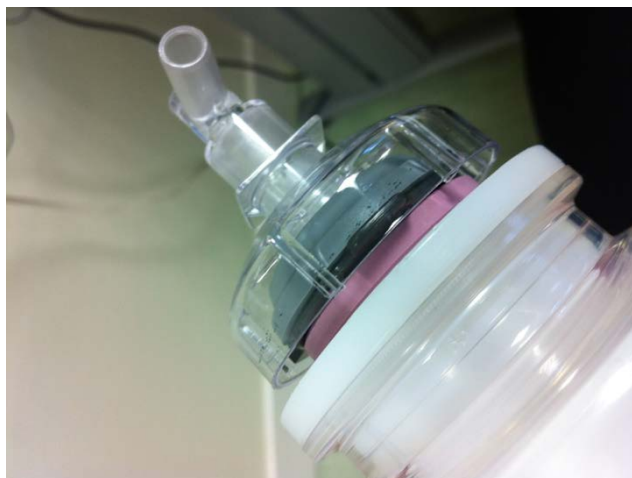
Schéma 3 : Photographie de la tête du bol montant le joint carbone (noir) et le joint céramique (rose)
