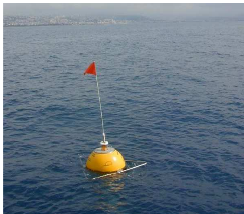
Figure 26 : Bouée houlographique du réseau CANDHIS
