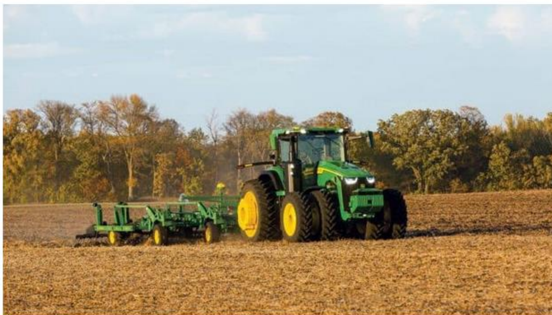
Le John Deere 8R410 autonome utilise un autoguidage RTK et un système d'analyse de son environnement pour détecter d'éventuels obstacles. (Crédit: John Deere)
