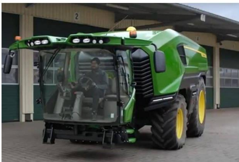
Pour se déplacer d'une parcelle à l'autre, un relevage avant permet de fixer une cabine sur le SESAM.
