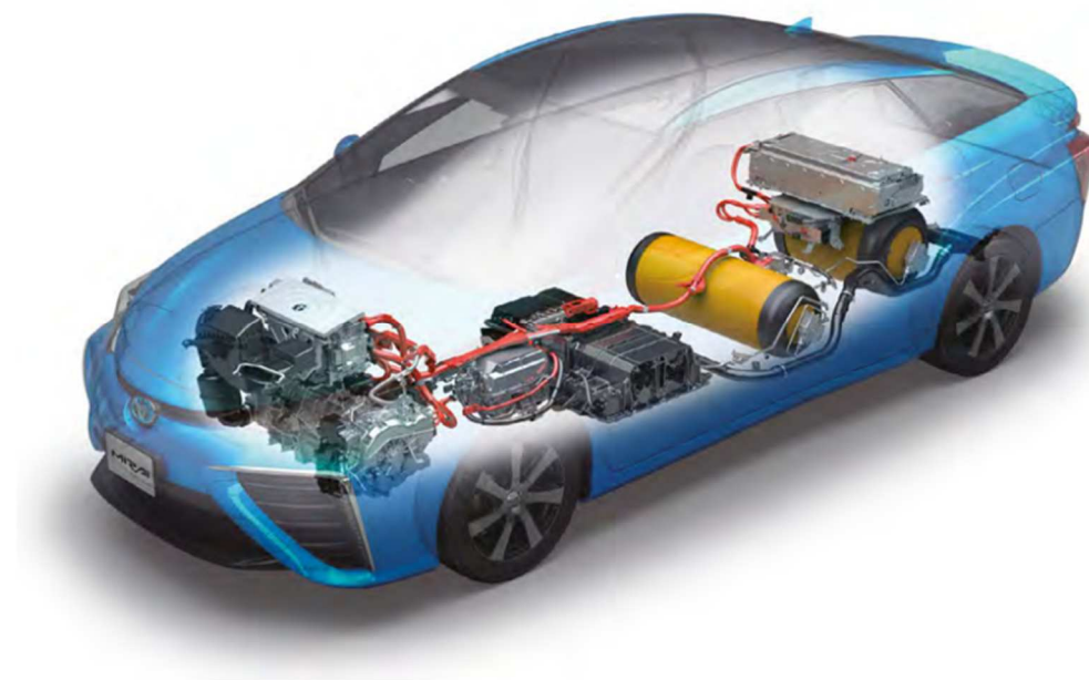
Figure 5 : Eclaté d'une voiture Toyota Mirai 51 .
