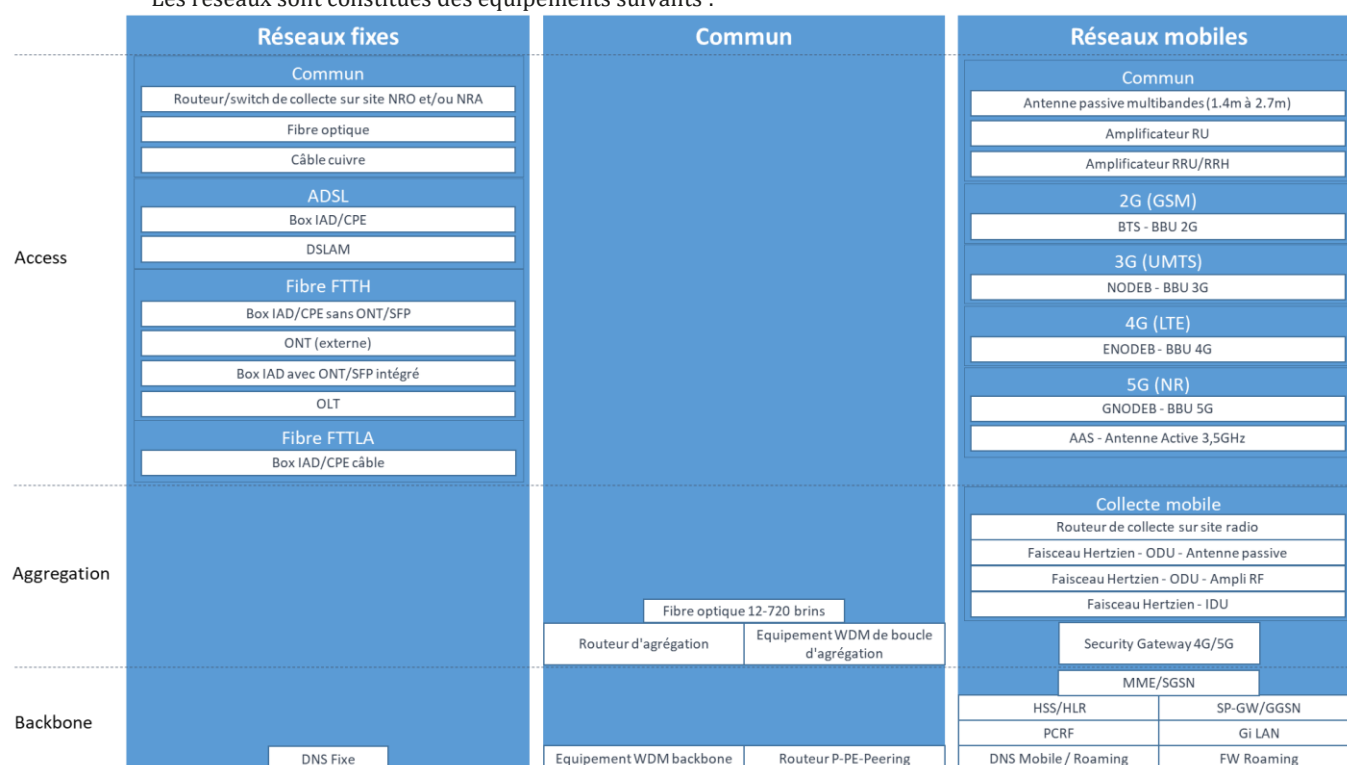
Figure 7 - Equipements constitutifs des réseaux
