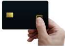
Graphique 4 : Exemple de carte à puce biométrique dotée d'un lecteur d'empreinte digitale
