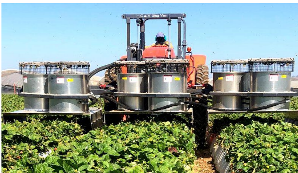
Figure 9 : aspirateur mécanique de punaises sur fraisiers en Californie (Source : Calstrawberry)
