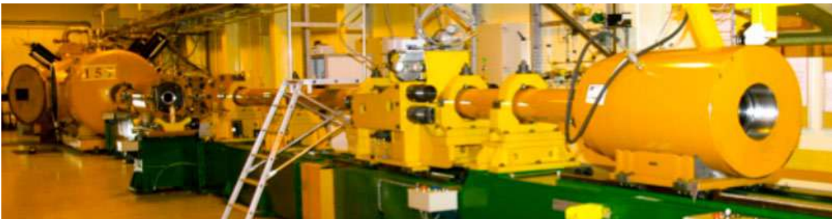
Lanceur à poudre pour l'essai dynamique de projectiles
