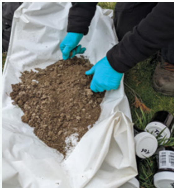
Prélèvement de sol superficiel dans un parc public à la suite d'un incendie sur un centre de tri de déchets.
