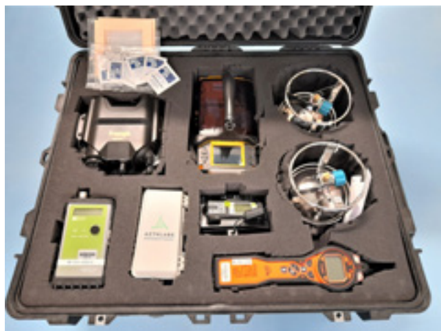
Une des 3 valises constituant un kit de niveau 1 (contenant quelques équipements de prélèvement et tous les instruments de mesure à l'exception du GC/MS portable).
