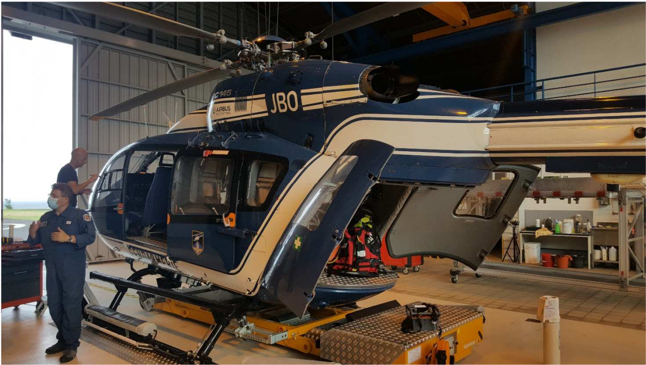
Photo n°2 : EC 145 de la gendarmerie en maintenance par la SAG
