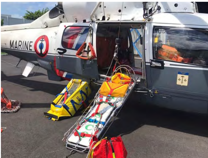
Illustration n°6 : Equipement de secours hélitreuillé de l'hélicoptère Dauphin
