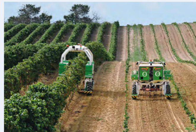
À gauche, le robot enjambeur TED permet de désherber entre les rangs et sous le rang ; à droite le robot Orio, assure le binage et le désherbage dans les rangées de cultures. Ces robots, de la société Naïo, sont autonomes et ne nécessitent pas de supervision. Photo : NAÏO
