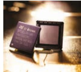
Sur son unique centimètre carré, la puce Oxford-2 fait transiter un flux de données de 1 Gbit/s, l'équivalent de la fibre optique.
