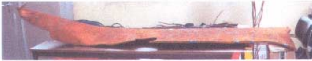
Figures 1 – 2 – 3 – 4 – 5 : Vues générales du prélèvement – opercule ouvert – déformation permanente importante – présence d'hydrocarbures noirs adhérents – marques bleues au droit des cordons de soudure discontinus (« réparations »).
