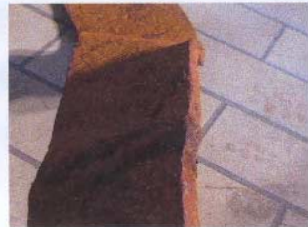
Cordon desoudure de continuité (cordons interpénétrés).
