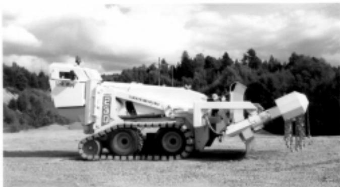
Le compact 230 "MINECAT" est un véhicule blindé polyvalent équipé d'un fléau de neutralisation de mines résistant jusqu'à 10 kg d'équivalent TNT.
