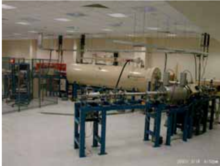
Artemis : l'accélérateur pour la recherche en science de la terre, environnement, muséologie implanté à Saclay, laboratoire de mesure du carbone 14, dédié aux datations, ( LMC14, UMS 2572)
