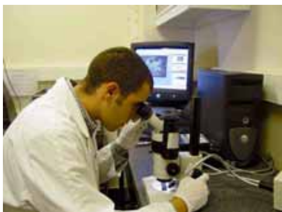
Recherche sur la dégradation des bandes magnétiques au CRCDG- observation sous binoculaire de l'état de dégradation prélèvement pour analyse chromatographique CRCDG
