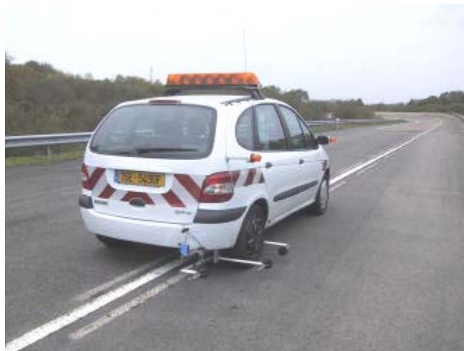
Photo 1 : Dispositif de mesure du bruit de contact pneu-chaussée en continu
