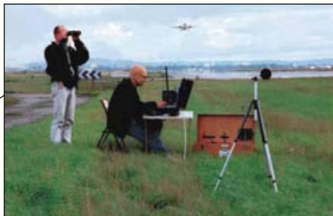
Ingénieurs du STAC procédant à des mesures de bruit pour la certification acoustique d'un aéronef.
