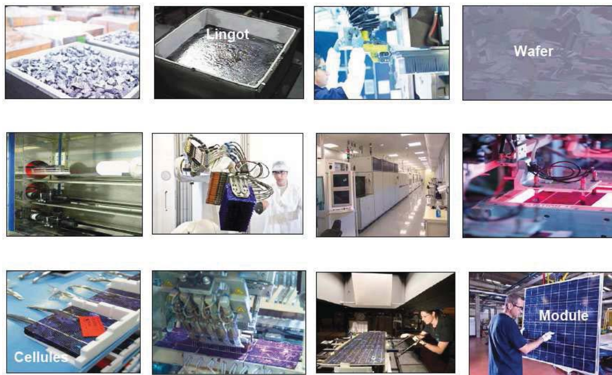
Graphique 4 : Illustration de la chaîne de production des panneaux photovoltaïques
