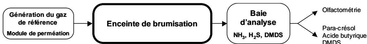
Figure 29. Représentation schématique des éléments du banc d'essai
