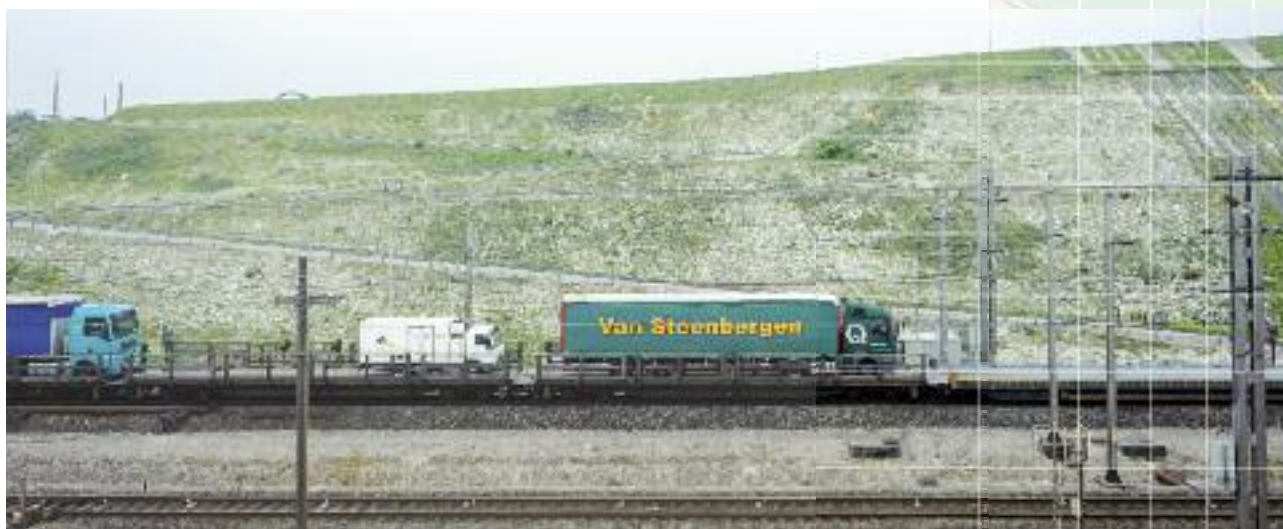
# FERROUTAGE DE CAMION SUR TRAIN
