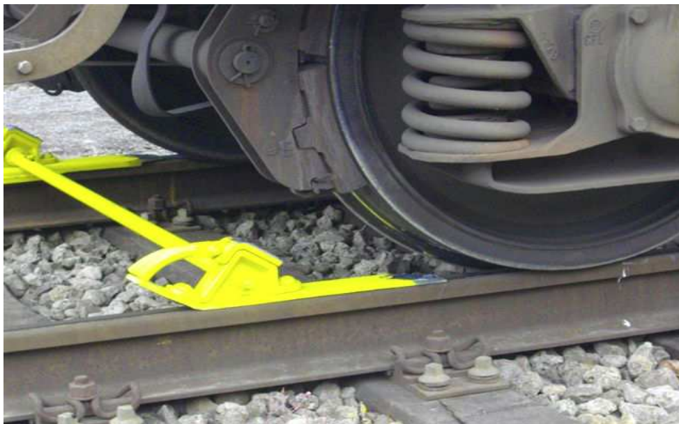
Cale double utilisée à Bettembourg
