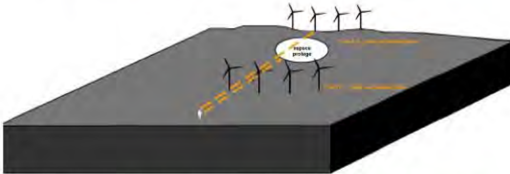
Fig.2 : la covisibilité (visible avec) directe : depuis un espace public, le parc éolien et l'espace protégé, se superposent visuellement ( 2 cas : les éoliennes sont en avant plan - les éoliennes sont en arrière plan). DREAL Centre, nov. 2013
