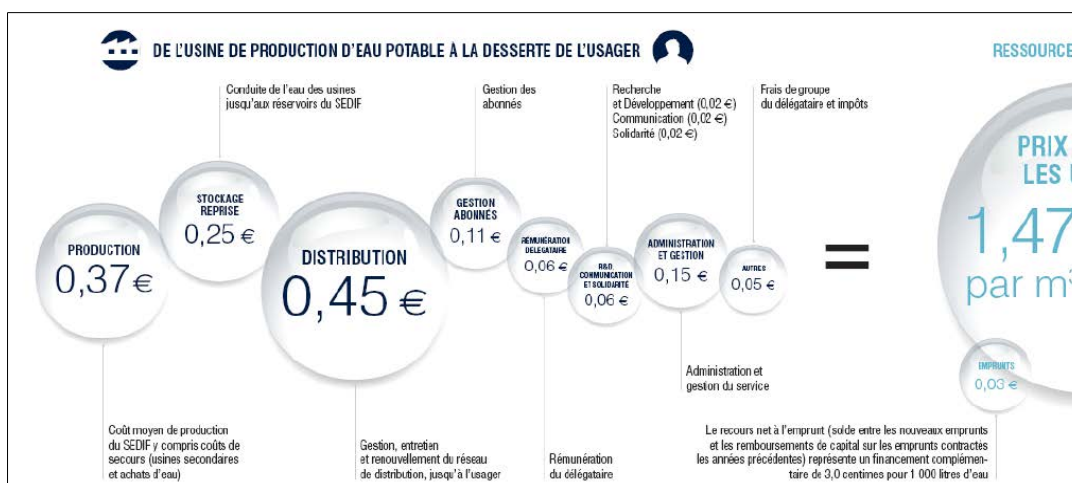
Figure 46: Explications de la formation des prix de l'eau potable du SEDIF. Source : SEDIF, 2014.
