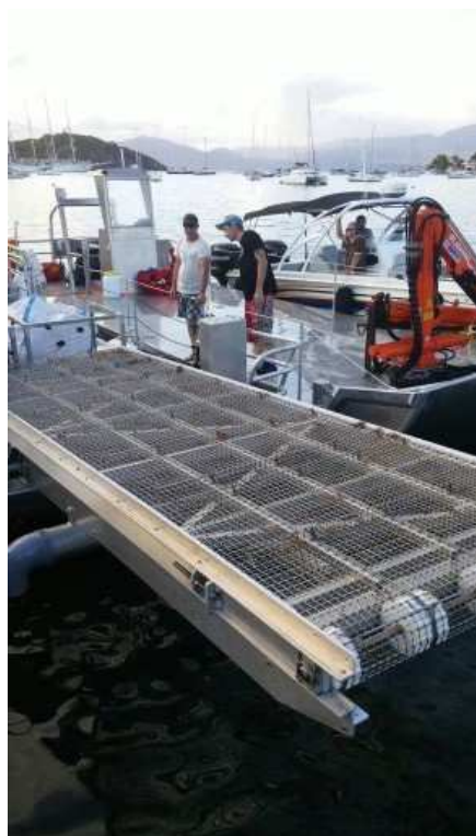
Photo 17: Convoyeur sur barge "Sargator"
