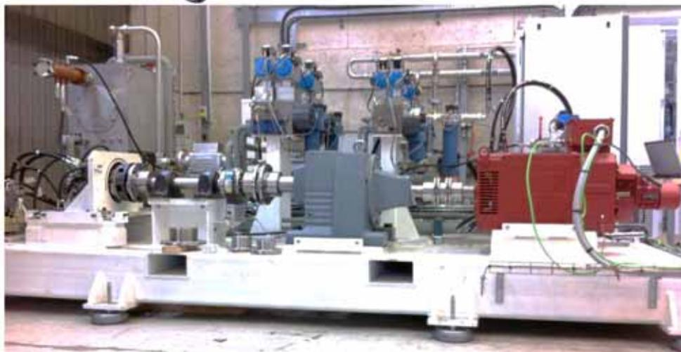
D'autres bancs nous permettent aussi de réaliser des tests d'endurance, de coups de bélier, de pulsation de pression, de composants d'injection diesel, d'enveloppes de composants hydrauliques (vérins, accumulateurs)
